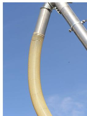
◀ **Beweglicher PU - Ablaufschlauch Ø150 mm**
